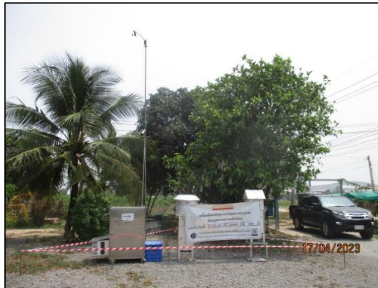
รูปที่ 3.4 การเก็บตัวอย่างคุณภาพอากาศในบรรยากาศ บริเวณชุมชนบ้านเขาดิน (A4)
