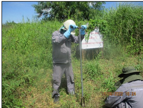
รูปที่ 3.23 การเก็บตัวอย่างคุณภาพดิน บริเวณพื้นที่สีเขียวด้านทิศใต้ (S2)
