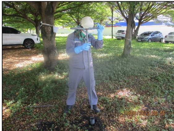
รูปที่ 3.22 การเก็บตัวอย่างคุณภาพดิน บริเวณพื้นที่สีเขียวด้านทิศเหนือ (S1)
