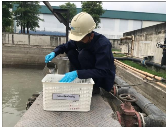
รูปที่ 3.11 การเก็บตัวอย่างคุณภาพน้ำเสีย บริเวณ EQ Tank
