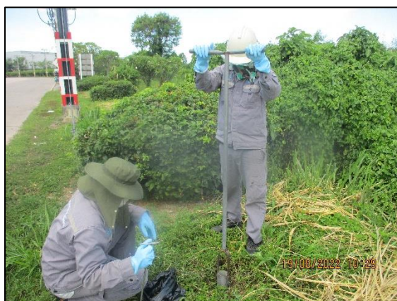
รูปที่ 3.23 การเก็บตัวอย่างคุณภาพดิน บริเวณพื้นที่สีเขียวด้านทิศใต้ (S2)
