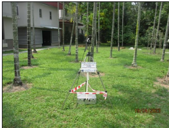
รูปที่ 3.6 การตรวจวัดระดับเสียงโดยทั่วไปและเสียงรบกวน บริเวณสำนักงานโครงการนิคมอุตสาหกรรม ปิ่นทองโครงการ 1 (N2)
